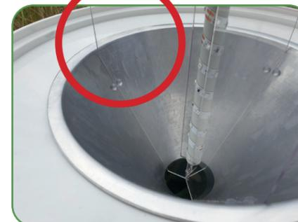
Legen Sie die Platten zwischen die Bolzen.
