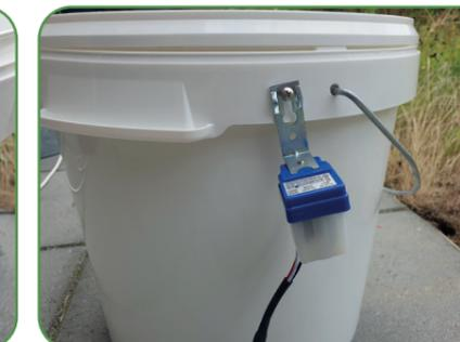
Der Lichtsensor ist an der Schraube befestigt.
