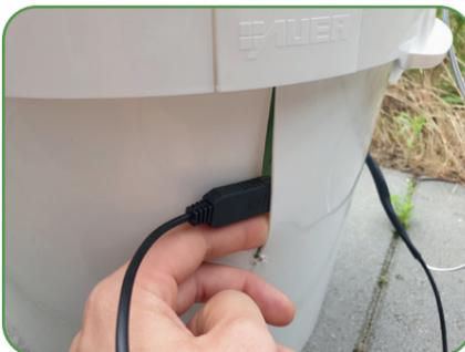
Öffnen Sie den Schlitz leicht mit den Fingern, damit der USB-Stecker hindurchpasst.
